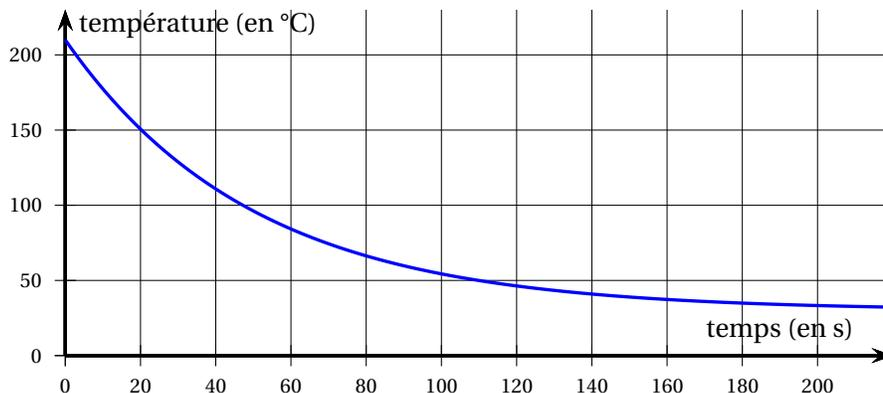
1. L'objet peut être démoulé lorsque sa température devient inférieure à 50°C.
